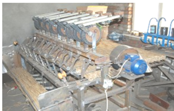
Рис. 1: а – ручной станок; б – матовязальный станок МВС-150
