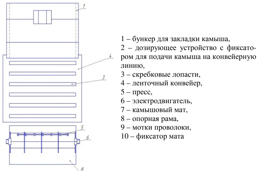
Рис. 2. Автоматизированный станок для изготовления камышовых матов
